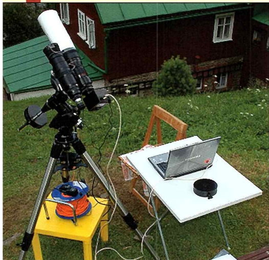
Obr. 1. Zostava s ktorou som pozoroval tranzit HAT-P-6b. Sonnar 4/300 v spojení s CCD G2-402.
