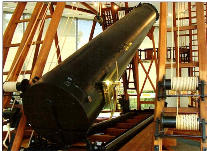
Pohyb ďalekohľadu bol zabezpečený pomocou valcov, koľajníc, ozubených súčastok, kladiek a silných lán.
